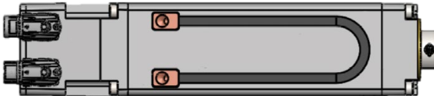
Abbildung 4.5: Ansicht der Wasserkühlungsoption CSWX
